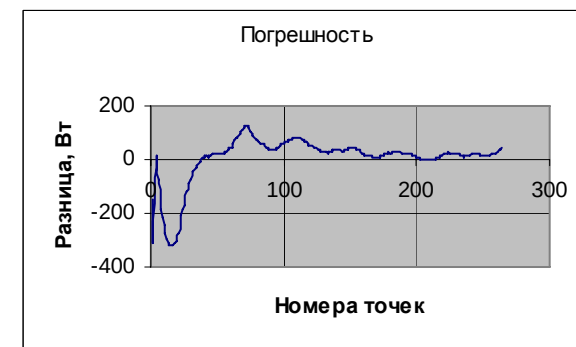
Рис.6. Разность между вычисленными и экспериментальными значениями мощности
