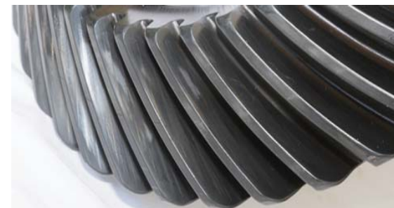
Рисунок 4 – Состояние зубчатых колес с ионно-плазменным азотированием
