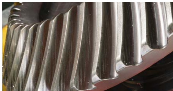
Рисунок 5 – Состояние зубчатых колес с цементированными зубьями
