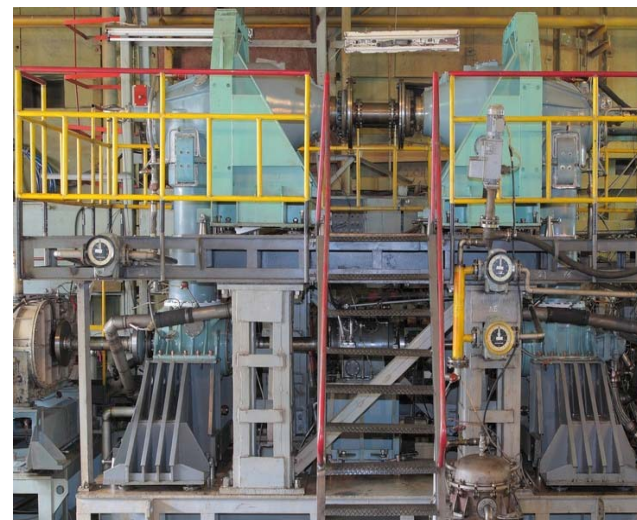
Рисунок 3 – Внешний вид испытательного стенда редукторов по замкнутому контуру
