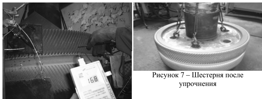
Рисунок 6 – Останавливание охлаждения. Самоотпуск. Контроль температуры
