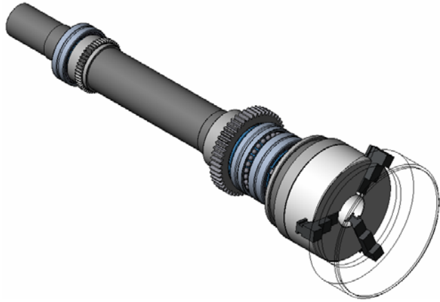
Рисунок 2 – 3D модель шпинделя универсального станка C10MB
