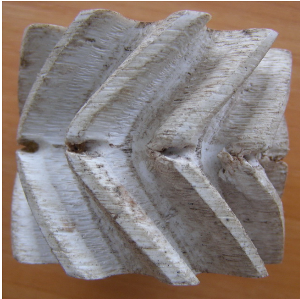
Рисунок 1 – Колесо с изношенными зубьями
