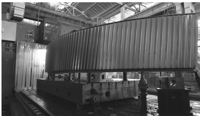
Рисунок 2 – Нарезка зубьев на секторе зубчатого колеса на станке с ЧПУ "TOS KURIM"
