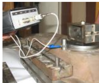
Рис.2. Закрепление датчика и измерительно-фиксирующего прибора на макете
