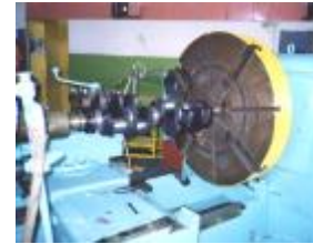
Рис.5. Дискретне зміцнення колінчастого вала двигунів Д80 і КамАЗ-740
