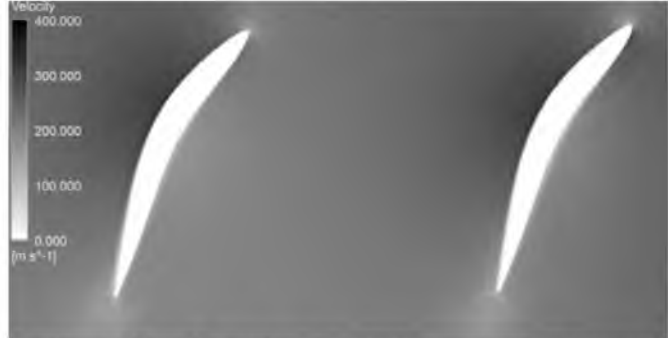
Рис. 2 – Фрагмент мгновенного поля скорости при обтекании решетки профилей для углов атаки i = -5^\circ и числа Маха M = 0,729
