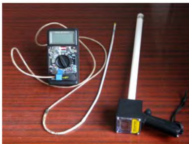
Рис. 2 – Система для измерения изменений температуры (слева) и прибор “Draminski estrous detector” для измерения электрического сопротивления (справа)
