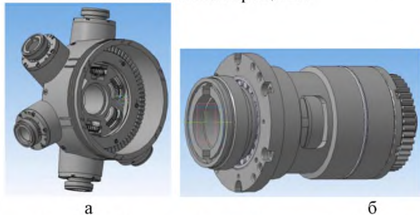
Рис. 3 – 3D-модели формообразующих узлов: а – шестишпindleвая револьверная головка; б – шпиндельный узел
