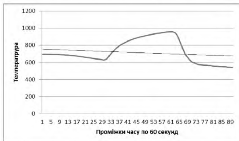
Рис. 6 – експоненціальне усереднення температури у точці Дно 2 на протязі роботи пальників із циклом переключення 30 хвилин
