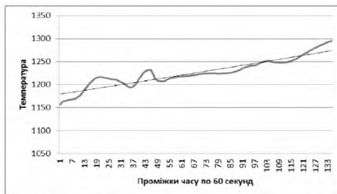
Рис. 9 – експоненціальне усереднення температури у точці Середина на протязі роботи пальників із циклом переключення 45 хвилин
