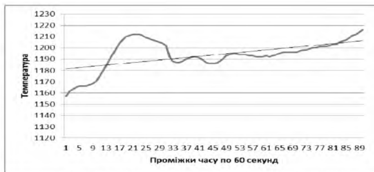
Рис. 7 – експоненціальне усереднення температури у точці Середина на протязі роботи пальників із циклом переключення 30 хвилин
