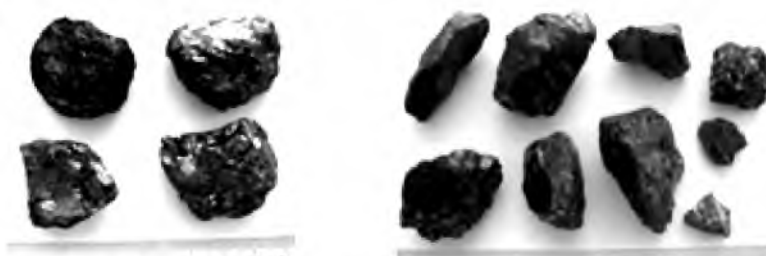
Рис. 2 – Фото антрацита (слева) и термоантрацита (справа)
