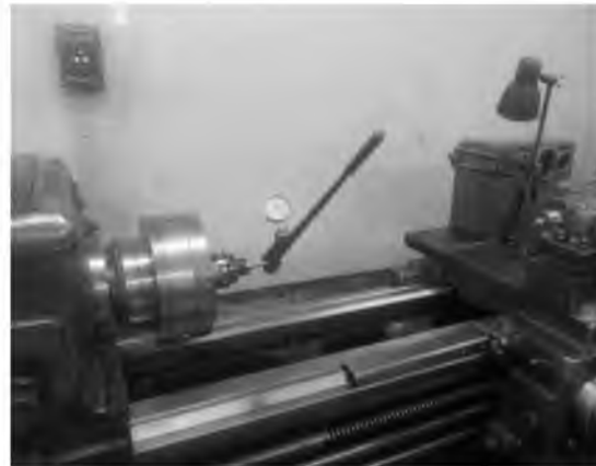
Рис. 3 – Измерение момента прокручивания M_{pr} оправки d=12 мм
