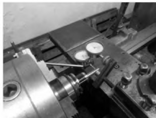
Рис. 11 – Измерения радиальной жесткости j_r оправки d=12 мм
