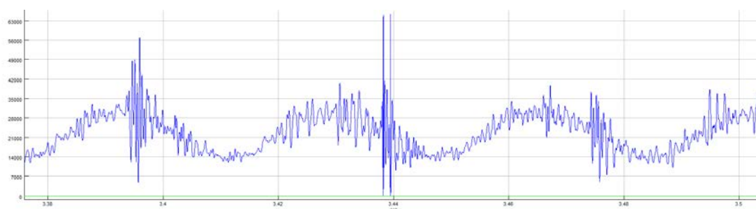
Рис. 5 – Исходный низкочастотный сигнал одного цикла работы двигателя 720°
