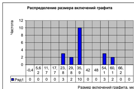
Рисунок 3. Характеристики микроструктуры чугуна, модифицированного ФС75
