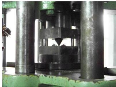
Рис. 4 – Экспериментальная оснастка для изгиба на 120°
