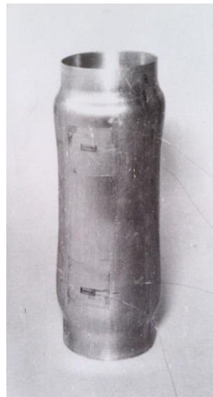
Рис. 2 – Образец после свободной растяжки
