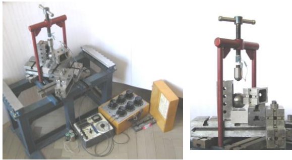
Рис. 2 – Общий вид экспериментальной установки для исследования контактного взаимодействия шарового поршня с беговой дорожкой радиальной ГОП
