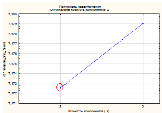
Рис. 8 – Графік залежності логарифму правдоподібності від кількості компонент в суміші потужності навантаження.
