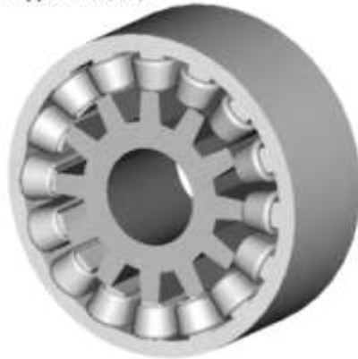
Рис. 1. Конструктивна схема ЕМП 4-секційного ВРД
