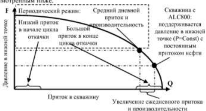
Рис.1. Характеристика P-Q скважины и увеличение ее производительности по сравнению с периодическим режимом работы при поддержании постоянства давления (уровня жидкости) в скважине.
