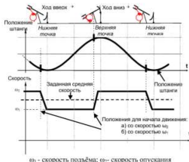
Рис.4. Задание скорости качания при двухскоростном режиме работы.
