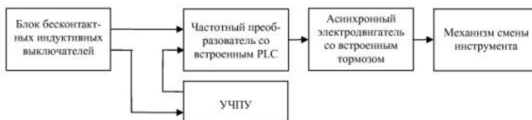
Рис. 2 – Структурная схема электропривода механизма транспортировки инструмента
