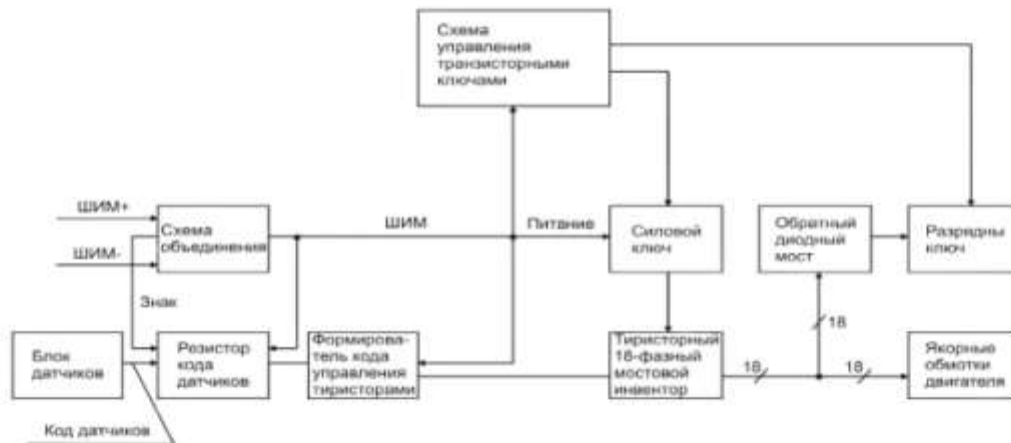
Рис. 3 Функциональная схема коммутатора с кольцевым включением обмоток
