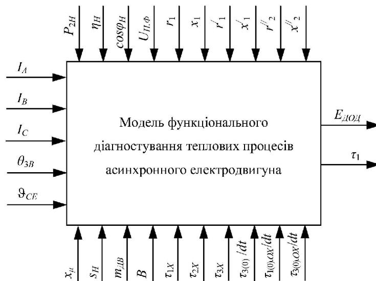
Рис. 2. Структурна схема моделі функціонального діагностування асинхронного електродвигуна за температурою сталі та силою струму статора
