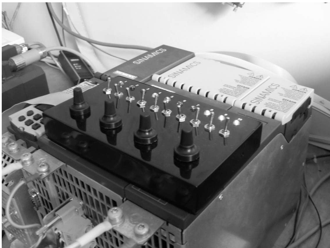
Рис. 1 Преобразователь Sinamics s120, входящий в состав созданной лабораторной установки
