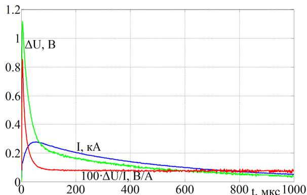
Рисунок 3 – Переходной процесс в БК при заряде
