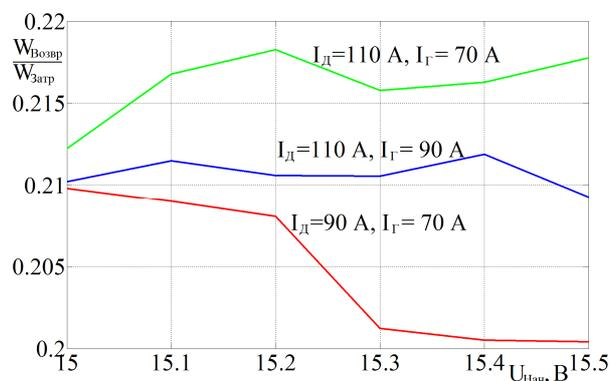
Рисунок 8 – Отношение возвращаемой к затрачиваемой энергии
