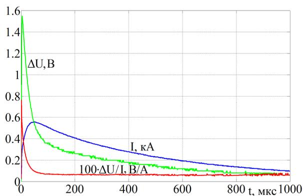
Рисунок 2 – Переходной процесс в БК при разряде
