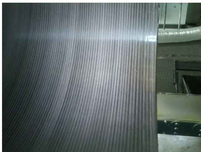
Рисунок 1 – Внутренняя поверхность трубы после обработки
