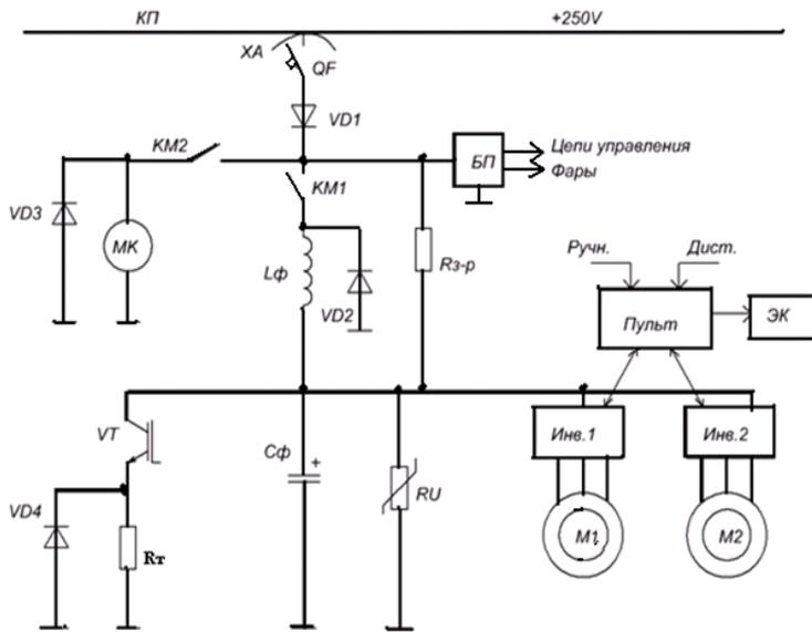
Рис. 8. Упрощенная схема контактного электровоза с асинхронным приводом
