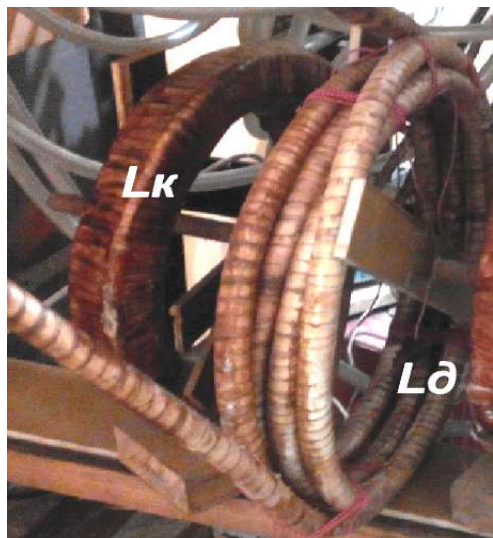
Рис. 3 Фотографія конструкції магнітозв'язаних котушок L_K та L_D
