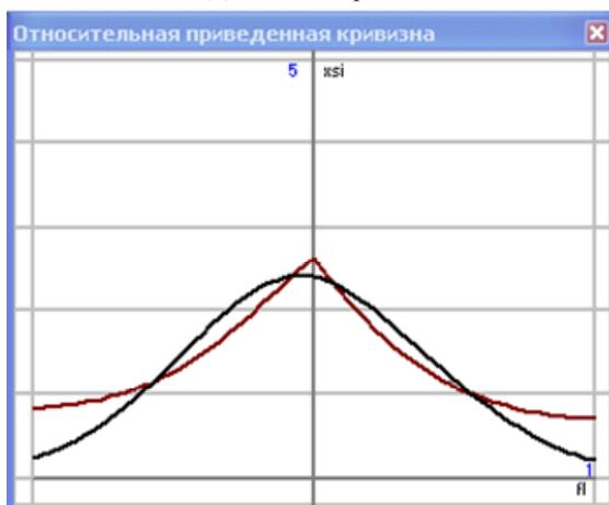
Рис.3. Относительная приведенная кривизна исходного контура СЧУ-4,4Д и новой передачи
