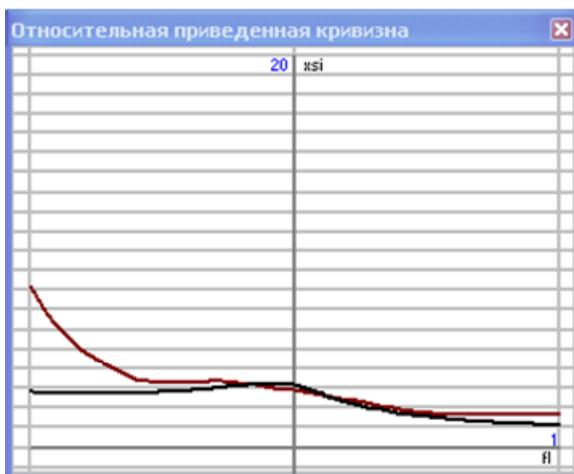
Рис.1. Относительная приведенная кривизна исходного контура СНУ - 1Д и новой передачи
