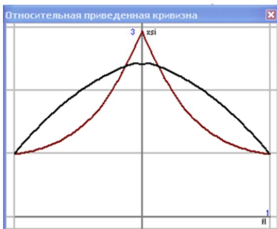
Рис.2. Относительная приведенная кривизна исходного контура СЧУ-3,9Д и новой передачи
