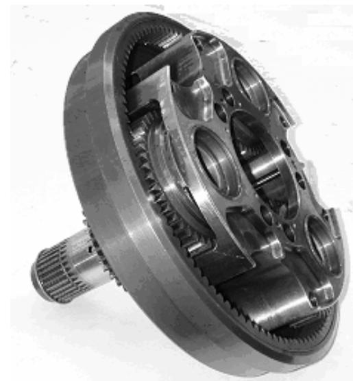
Рисунок 10 – Эпицикл и водило первой ступени в сборе
