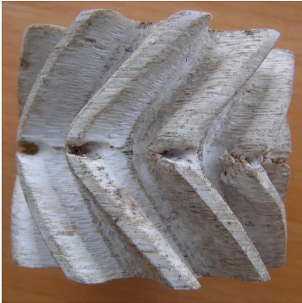
Рисунок 1 – Колесо с изношенными зубьями
