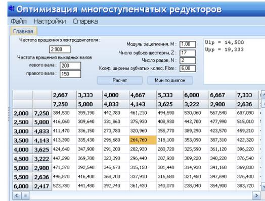
Рисунок 6 – Окно исходных данных и результатов расчета оптимальных кинематических параметров двухпоточного зубчатого редуктора по критерию минимизации его объема:  $u_{n1} = 14,5; u_{n2} = 19,333$
