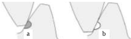
Рисунок 11 – Участок профиля ведущего зуба, который дважды за цикл зацепления входит в контакт: а – вне линии зацепления; б – на линии зацепления
