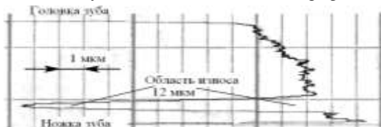
Рисунок 2 – Эвольвентограмма профиля зубчатого колеса z=49, \alpha=25^\circ, F_{\text{из}}=22909\text{Н} после испытаний
