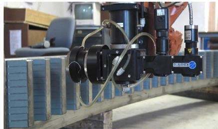
Рисунок 3 – Шестерня с диаметром  $d=2500$  мм с поверхностной закалкой посредством лазерного луча [5]
