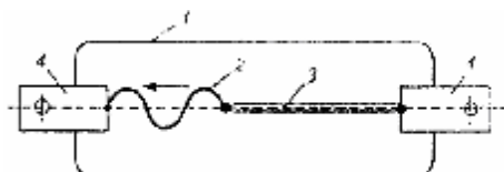
Рис. 3. Схема предохранителя с приводным элементом из сплава с ЭПФ: 1 – корпус; 2 – термочувствительный элемент; 3 – вставка; 4 – токоподводящий элемент
