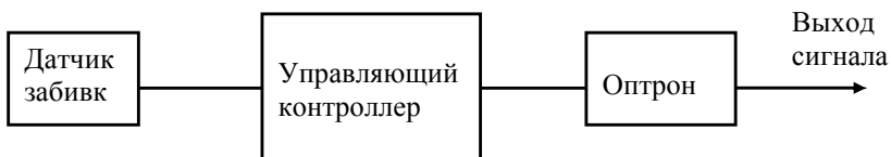
Рис. 3 – Схема контроля наличия материала на транспортной ленте.
