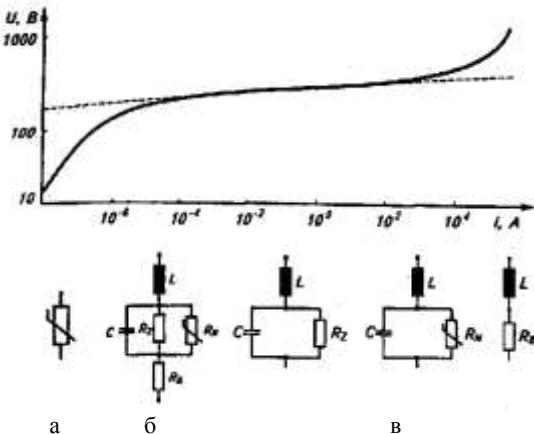
Рис. 2 – Вольт-амперная характеристика варистора и ее эквивалентные схемы замещения: *а* – обозначение ОПН на схемах, *б* – эквивалентная электрическая схема замещения нелинейного резистора, *в* – упрощенные схемы замещения, соответствующими трем различным зонам этой характеристики
