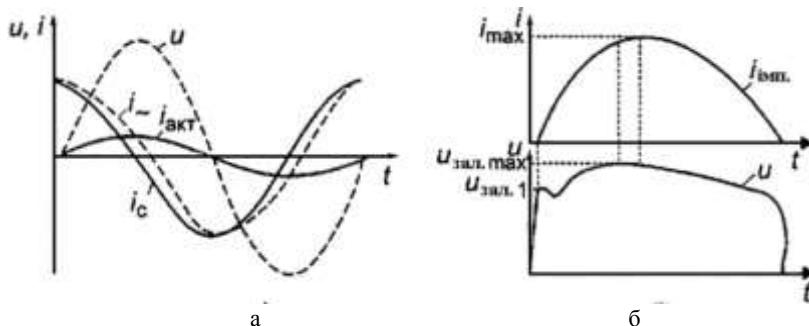
Рис. 3 – Ток в варисторе: а – при переменном напряжении промышленной частоты; б – при импульсном напряжении с большим импульсным током  $i_{имп.}$ ,  $u(t)=u_{зап.}(t)$
