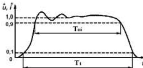
Рис. 1 – Прямоугольный импульс тока через ОПН:
