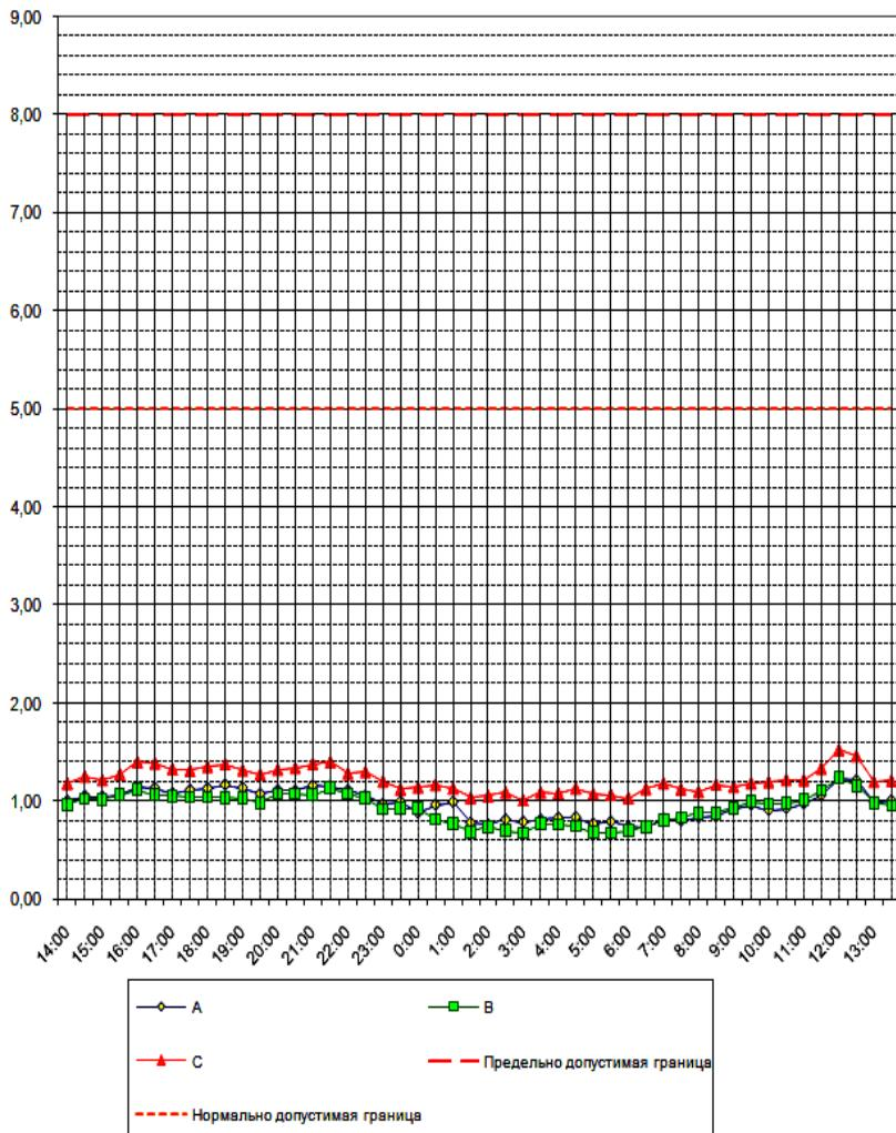
Рис. 5 – Коэффициент искажения синусоидальности кривой напряжения
