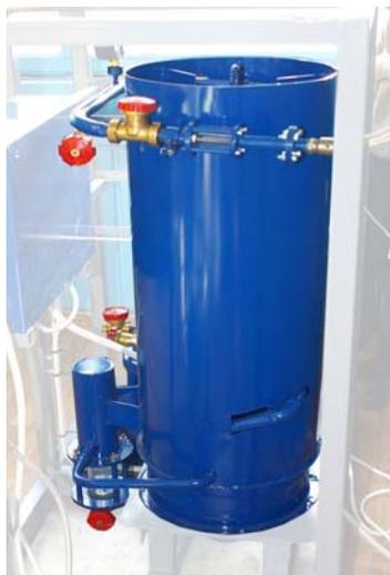
Рис. 2. Ресивер, совмещённый с теплообменником
