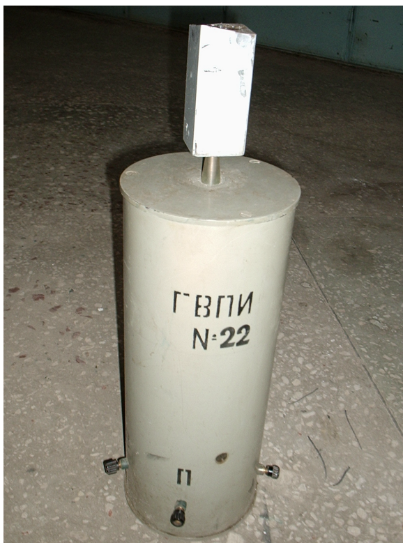
Рисунок 3 – Общий вид генератора ГВПИ на 100 кВ с разрушенным мощной электрической наводкой разделительным конденсатором C_p при срабатывании генератора ГИН-2 с выходным рабочим напряжением 1,2 МВ
