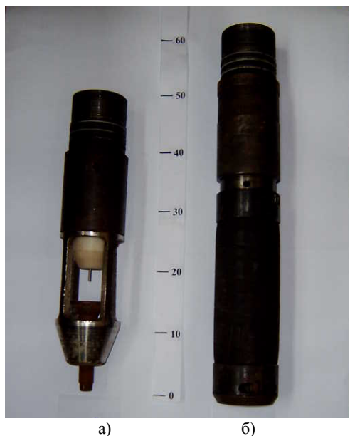
Рисунок 9 – Внешний вид электродных систем: а) – открытая электродная система; б) – закрытая электродная система
