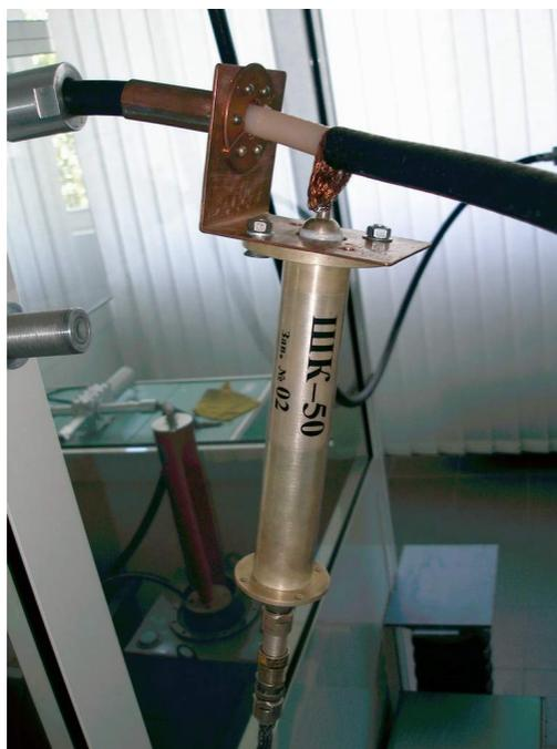
Рисунок 3 – Конструктивное исполнение включения шунта в цепь разрядного тока Эталона ИТ
