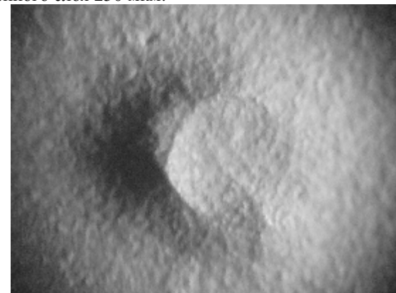
Рисунок 2 – Образец сегнетокерамического покрытия, нанесенного на медную подложку методом вакуумного аэрозольного напыления при комнатной температуре
