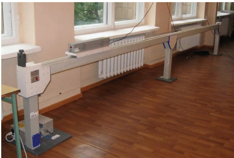
Рисунок 3 – Поглощающие клещи R&S MDS21 на автоматизированном направляющем рельсе
