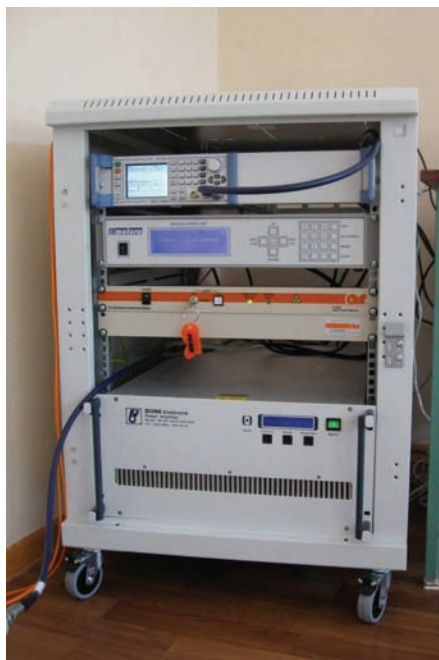
Рисунок 2 – Стойка с генератором, усилителем ВЧ и приборами дистанционного управления
