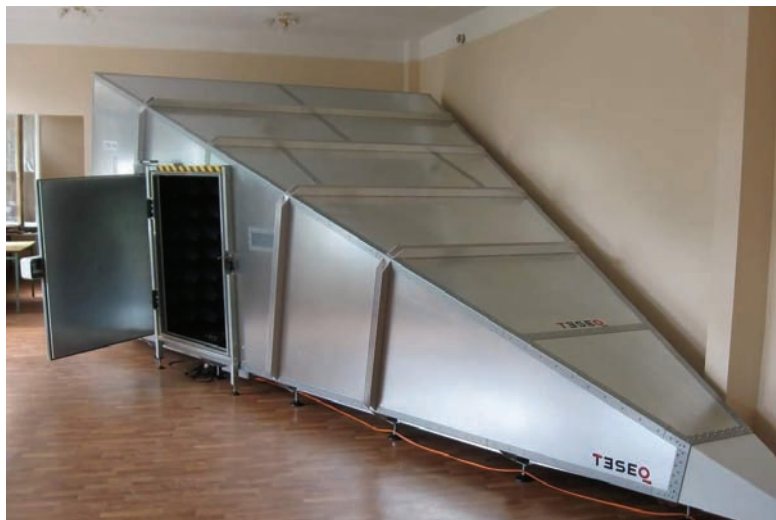
Рисунок 4 – Тестовая GTEM-камера TESEQ GTEM 1500 с открытой дверцей
