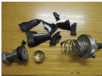
Рисунок 5 – Внешний вид фрагментов сработавшего отделителя
