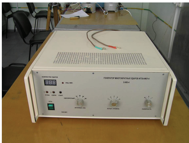
Рисунок 18 – Общий вид генератора ИГЛА-МКУ-4
