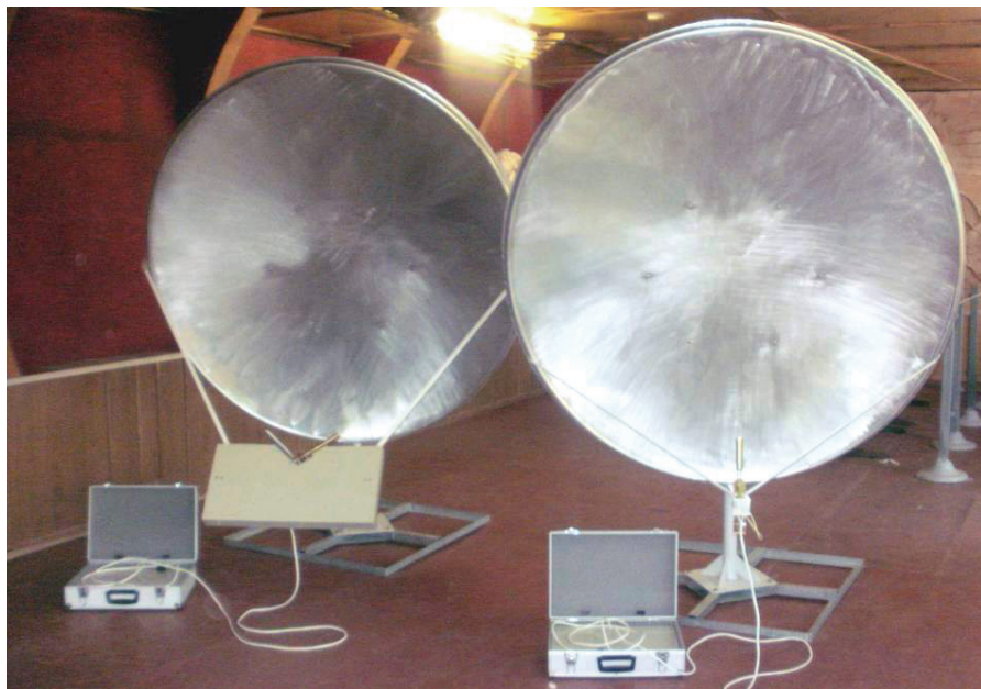
Рисунок – Испытательный комплекс (слева – горизонтальная поляризация, справа – вертикальная поляризация)
