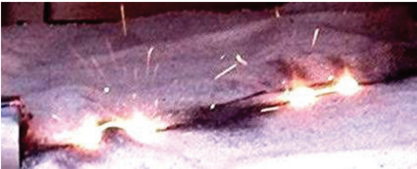
Рисунок 2 – Опытное распределение вдоль электротермически разрушенного оцинкованного стального провода ( r_0 = 0,8 мм; l_0 = 320 мм; \Delta_0 = 5 мкм) «горячих» (макроскопических зон ВЭП провода) и «холодных» продольных гантелеобразных участков, испытывающих воздействие апериодического импульса аксиального тока временной формы 9 мс/576 мс большой плотности ( \delta_{0m} = 0,37 кА/мм 2 ; n_m = 32 ; \bar{n} = 9 ) [7]
