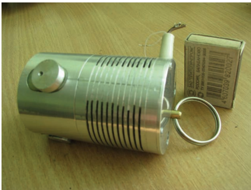
Рисунок 1 – Общий вид опытного образца устройства блокировки оперативных переключений УБОП
