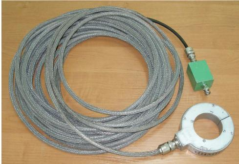
Рисунок 5 – Общий вид измерителя напряженности магнитного поля ИНМП-3-1000
