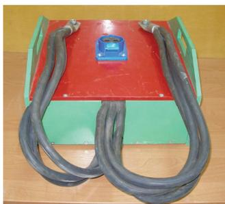
Рисунок 4 – Согласующий выходной трансформатор
