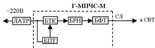
Рисунок 2 – Структурная схема установки У-МПЧС Г-МПЧС-М – испытательный генератор;
