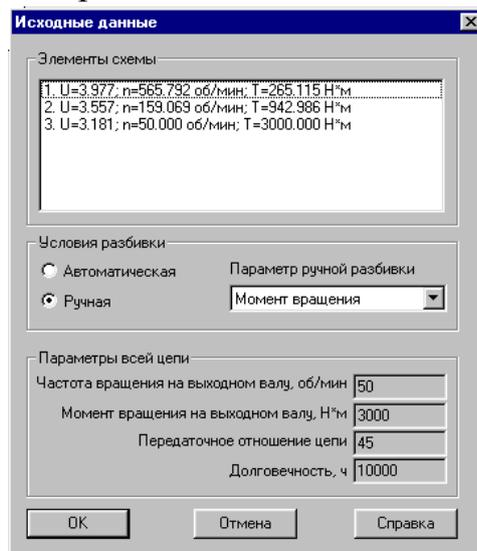
После окончания расчетов для просмотра результатов расчета следует выделить какой-либо интересующий элемент схемы и затем нажатием кнопки «Параметры» или «Результаты расчетов» можно просмотреть или исходные данные для расчета соответствующей зубчатой или червячной передачи или расчетную модель вала, или тип и геометрические параметры подобранного подшипника из базы данных.
