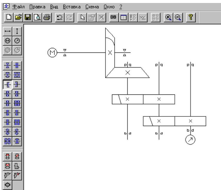
Необходимая информация для проведения расчета и проектирования всего многообразия приводов вращательного движения задается с помощью встроенного редактора задания произвольных кинематических схем. При работе в данном редакторе необходимо задать схему редуктора (выбрать число ступеней), а также задать типы передачи, типы подшипников качения и расположение валов.
