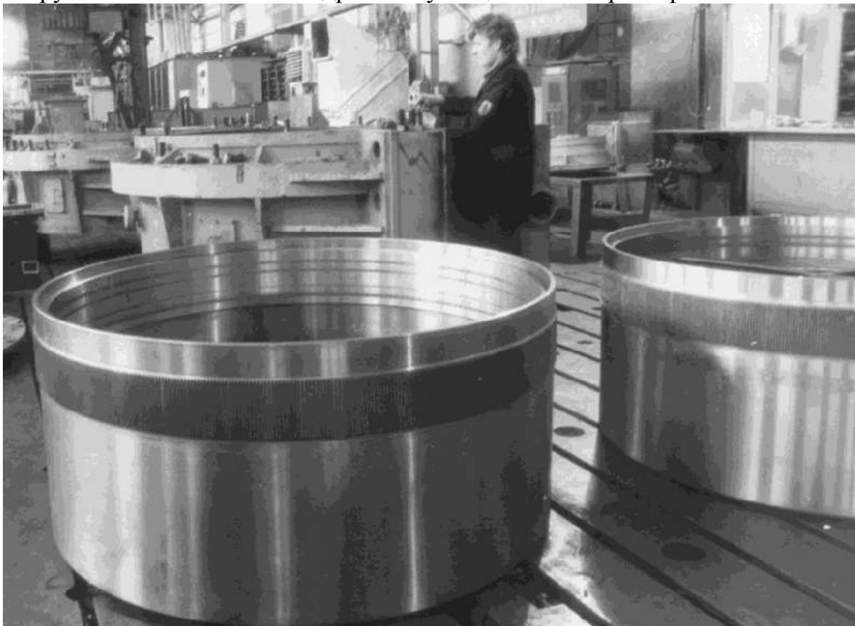
Рис. 1 Производство на АО НКМЗ волновых редукторов механизма шагания экскаватора ЭШ 10 × 70 с объёмом ковша 10 м 3 и вылетом стрелы 70 м
