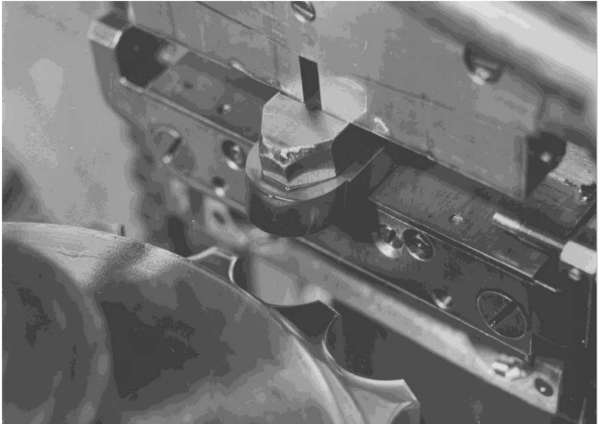
Рис. 2 Нарезка круговых зубьев на станке MAAG SH 450/500
